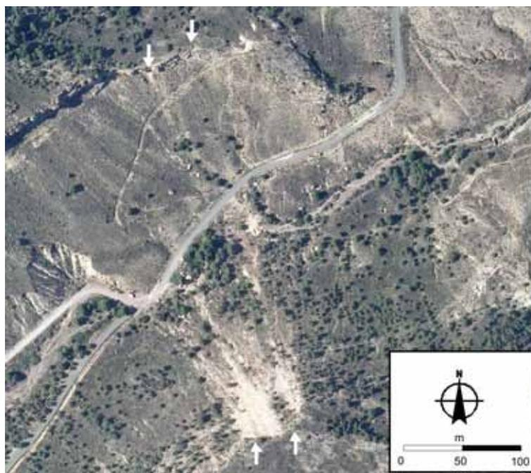
Figura 1. Vista aérea de las principales inestabilidades ocurridas durante el terremoto de Lorca de 2011 en las Rambla del Puente de los 17 Arcos.
