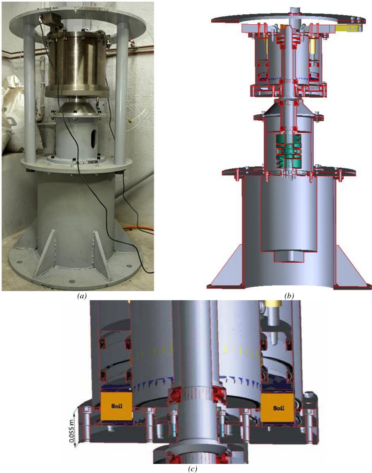
Figura.1. Nuevo equipo de corte rápido: (a) fotografía del prototipo (b) sección y (c) zoom de la muestra anular.
