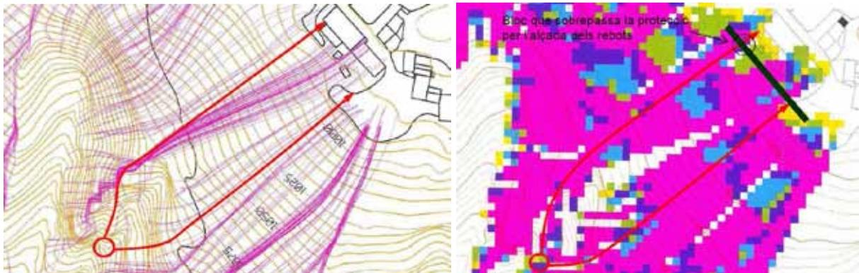
Figura 2: comparación de un caso real (2008) con la simulación realizada en el año 1998 en la zona del Solà d'Andorra. Si bien las trayectorias fueron fiables al 100%, la altura de los rebotes sobrepasó las protecciones (6m) y se tuvo que recalibrar el modelo con unos parámetros de rebote superiores a los que se utilizaron en su día.
