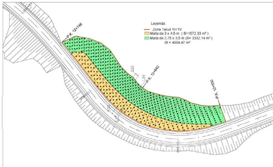
Figura 1. Esquema de la solución en el tramo A
