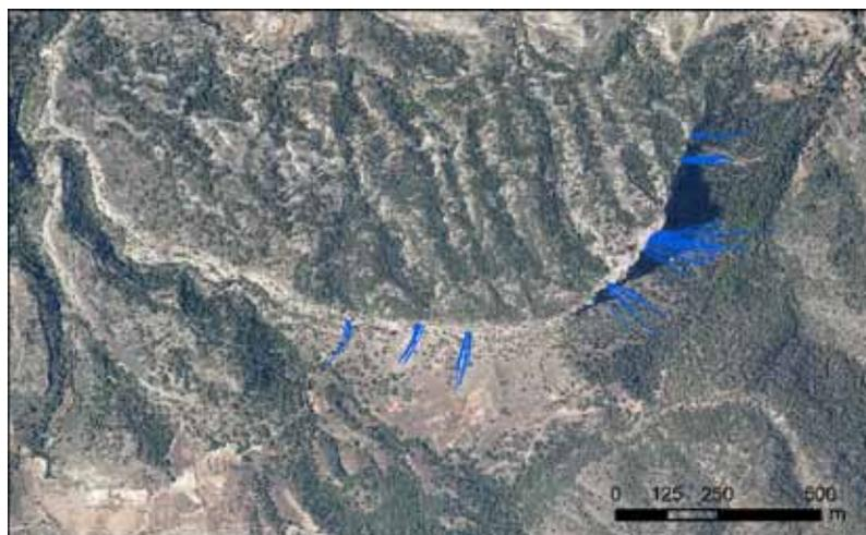
Figura 5. Ejemplo de trayectorias (líneas azules) de los bloques caídos durante el terremoto de Lorca de 2011 obtenidas mediante la herramienta Rockfall Analyst (Lan et al., 2007) para el sector del Cejo de los Enamorados.
